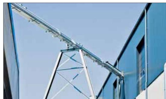
Der „Vecobelt“-Förderer transportiert das Material quer über den Hof zu den Lagerboxen und der Siebstation.
