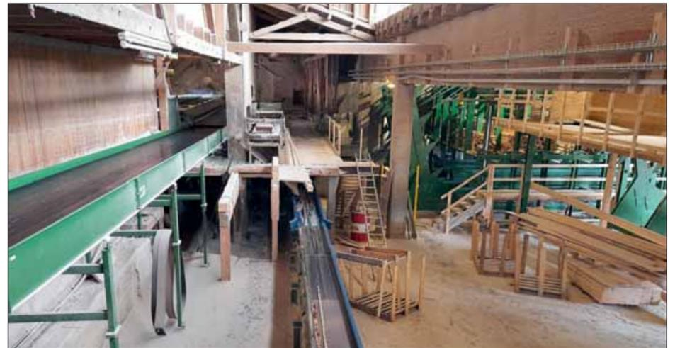
Seitenware und Model werden auf ein Längsförderband übergeben, das sie auf ein Doppeldeck vor dem Besäumer (hinter dem Betrachter) transportiert. Rechts im Hintergrund das Sortierwerk.
