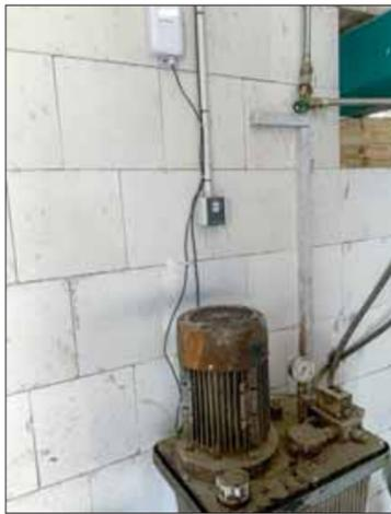
Schaltanlagen oder unzugängliche Motoren bergen u. U. ein Brandrisiko. Mit kabellosen Temperatursensoren können sie einfach permanent überwacht werden.
