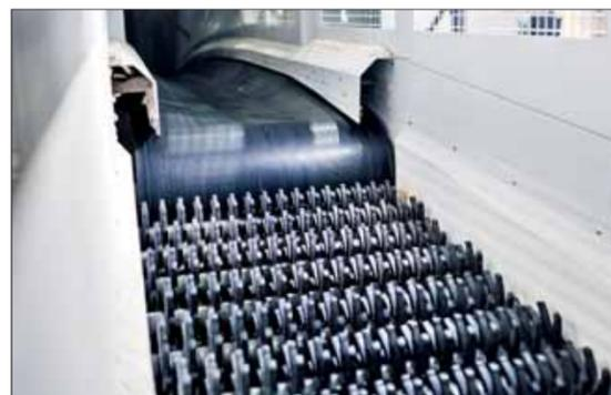
Das Sternsieb scheidet Überlängen aus dem Material ab. Die abgiebten Überlängen sowie anfallende Kappstücke ...
