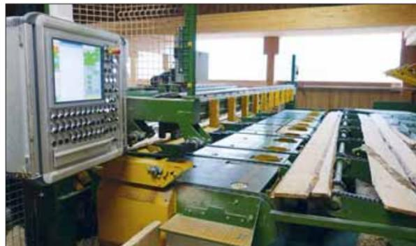
Die Beschickung des Säumers mit Seitenware erfolgt über einen Entzerrer vom unteren Deck (hier im Bild). Das obere Deck kann über heb- und senkbare Kettenförderer (rechts) entleert werden.
