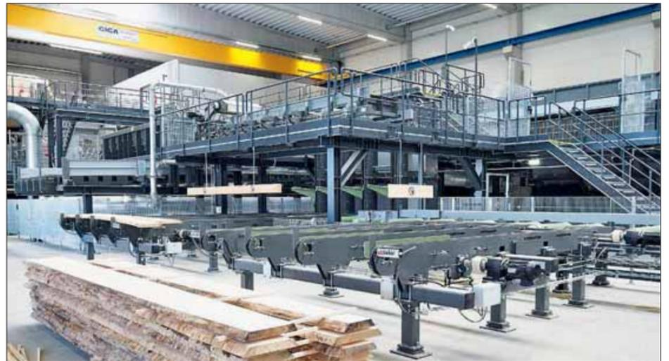
Blick in die Sägehalle bei Alsol in Vápenná: links an der Stirnseite der Halle die Blockbandsäge, an der Längsseite die Besäum- und Nachschnittanlage und darunter – mit Sicherheitszäunen abgegrenzt – die Entsorgungsanlagen; im Vordergrund die Plätze zur manuellen Abstapelung unbesäumter Schnittware
