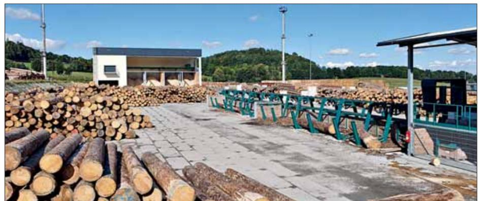
Der Rundholzplatz von Baljer und Zembrod ist auf Rundholzabschnitte bis 6 m ausgelegt. Hauptlänge im Einschnitt sind 4,1 m. Foto: Baljer und Zembrod
