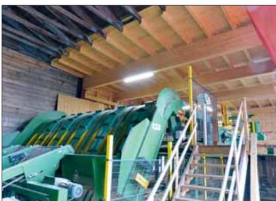
Haupt- und Seitenware werden chargenweise an derselben Station zu Paketen gestapelt.
