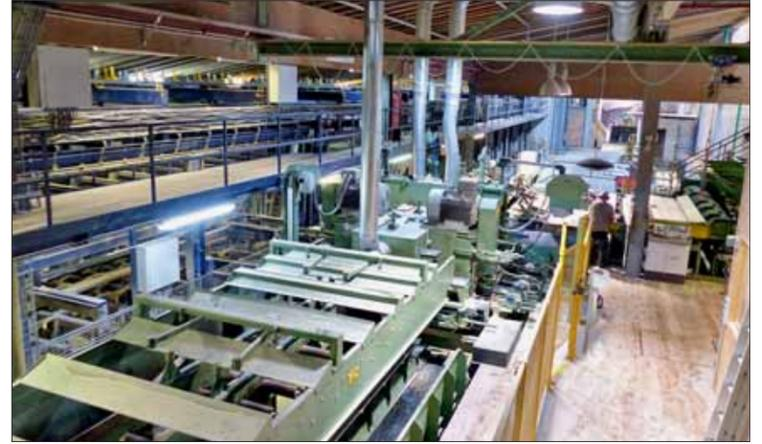
Kombinierte Nachschnitt- und Besäumanlage, links oben die Strecke zur Qualitätsbeurteilung und darunter die vertikalen Sortierboxen
