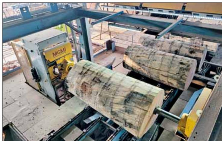
Einsatz eines „Logeye“-Stereoskopiscansystems zur Vermessung und Optimierung von Okoumé-Stammabschnitten für die Schälfnierproduktion bei CPL in Gabun. Hierfür werden entrindete Stammabschnitte mit Durchmessern von 600 bis 1500 mm und Längen von 1,0 bis 3,2 m eingesetzt. Fotos: Arbor-Gruppe
