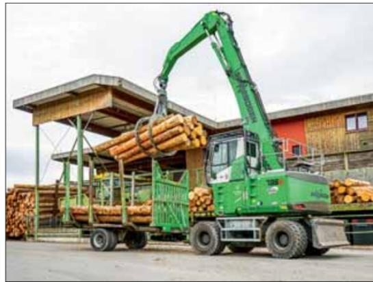
Elektrifizierte Umschlagbagger laufen größtenteils im Anhängerbetrieb und werden für längere Strecken im Werk genutzt.
