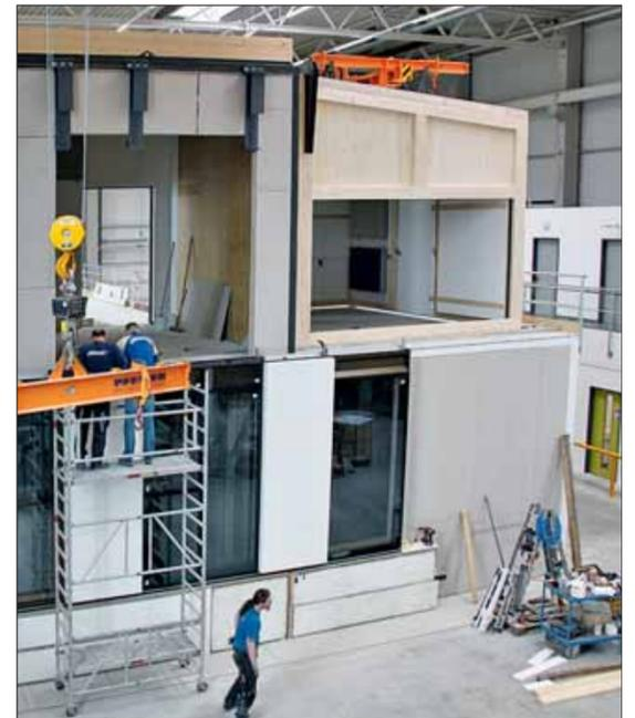
Neues IFT-Schall-Labor zur Prüfung von Bauelementen bis zu einer maximalen Abmessung von 11 x 12 m auf Luft-/Trittschall, Flankenschallübertragung nach nationalen, europäischen und amerikanischen Normen
