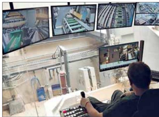
Der Bediener sitzt direkt über dem Spanner und hat über Bildschirme einen guten Blick aus allen wichtigen Richtungen auf den Prozess. Fotos: EWD (4)
