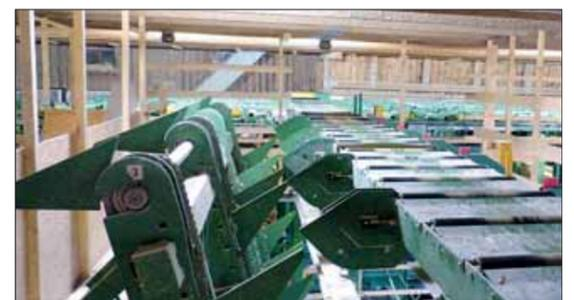
Rollengang zum Sortierwerk, links der Elevator zum Ausschleusen von Sondersortimenten
