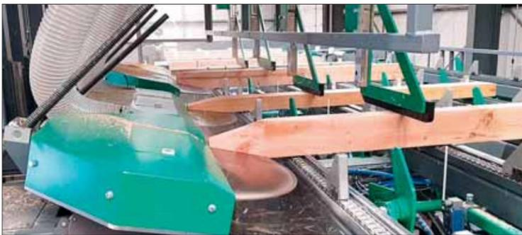
Vor der „Post-Pointing“-Station werden die Kanthölzer an der Nulllinie ausgerichtet und anschließend an vier Kreissägen vorbeigeführt. Zwischen zwei Kreissägen wird jedes Kantholz automatisch um 90° gedreht.
