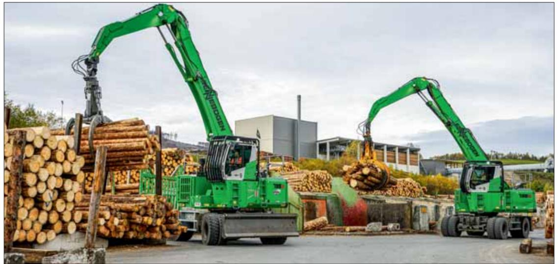
Bei Pieper-Holz in Olsberg arbeiten der diesel-elektrisch betriebene Umschlagbagger „735 E GED“ (links mit Anhänger) und die dieselbetriebenen „735 E“-Modelle parallel am Sortierstrang und übernehmen den Rundholztransport im Sägewerk.
