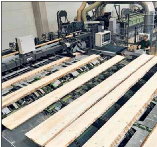
Besäum- und Nachschnittanlage mit Zuführung auf zwei übereinander liegenden Förderebenen zur Trennung von Bohlen und Brettern
