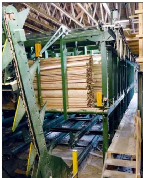
Sortierwerk mit 15 Fallboxen. Über den Elevator im Vordergrund wird der Puffer unten mit Hauptware befüllt
