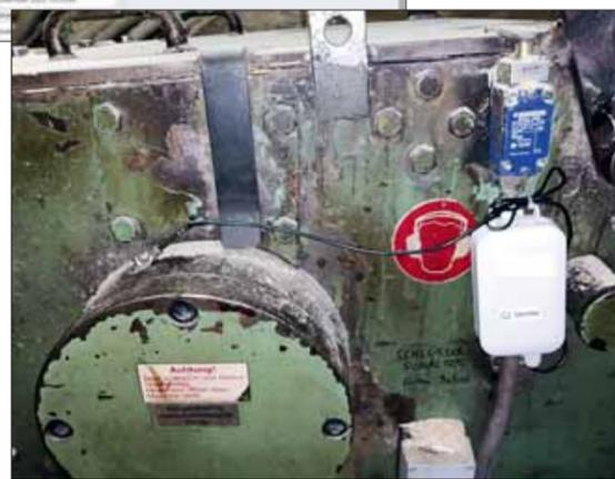
Produktion und produktionsfreie Zeiten nachts oder am Wochenende. Der aktuelle Zustand an überwachten Stellen ist jederzeit über eine Internetverbindung einsehbar, auch auf Mobilgeräten. Bei Bränden, die ohne Anbahnungsphase entstehen, alarmiert das System sofort, zusätzlich können auch Löscheinrichtungen ausgelöst werden.
