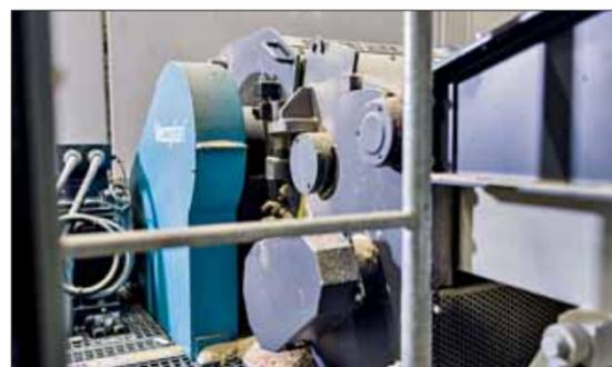
Der Trommelhacker zerkleinert das anfallende Restholz auf eine trocknerfähige Spangröße.
