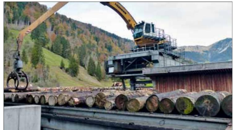
Das Sägewerk Erhart (oberes Foto) liegt auf 4 ha Betriebsfläche im Großen Walsertal im Vorarlberg. Auf dem Rundholzplatz wird der knappe zur Verfügung stehende Platz durch den Einsatz eines elektrisch betriebenen Portalbaggers bestmöglich ausgenutzt. Das untere Foto zeigt die Rundholzaufgabe für die 3D-Vermessung vor dem Einschnitt, ein Stockwerk über der Sägehalle. Fotos: J. Härer
