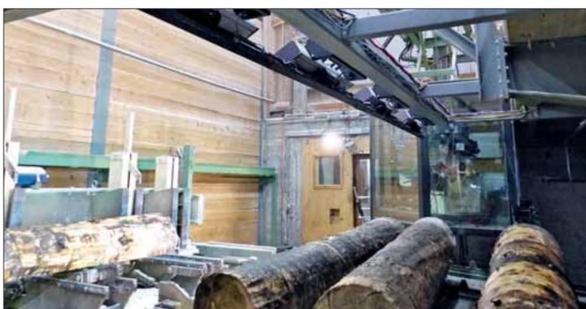
Das „Logeye“-System – hier bei Erhart-Holz mit vier Stereoskopie-Kameramodulen – ist direkt über der Aufgabe auf den Sägewagen angeordnet und liefert während der Drehung des Stammes in Echtzeit die exakte Position des Stammes im Raum. Gleichzeitig wird die von den Kameras erfasste Mantelfläche mit den Daten aus der zuvor erfolgten 3D-Vermessung im Längsdurchlauf abgeglichen.
