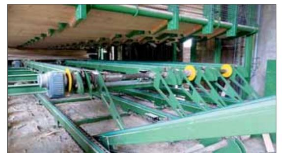
Weiche zwischen der Boxenentleerung (oben) und der Pufferebene für die Hauptwaren (unten)
