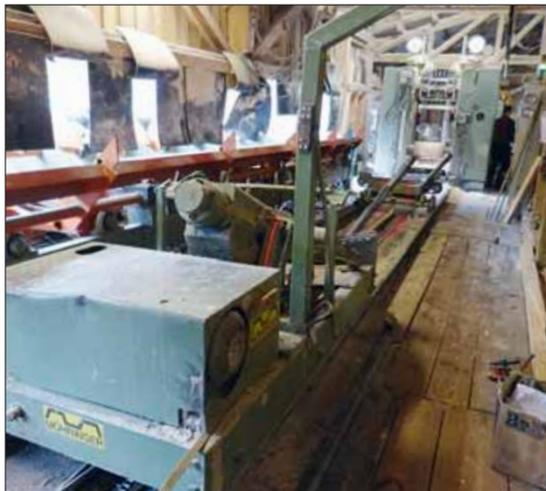
Hauptmaschine im Sägewerk Dirsch ist eine 2018 vollständig überholte Möhringer-Gattersäge.
