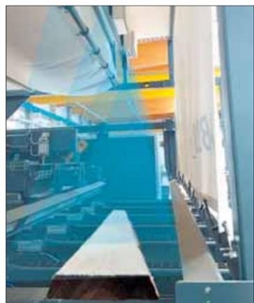
Hochauflösende Kameras vor dem Einzugschnitt zur Auftrennsäge geben ein geometrisch exakt kalibriertes Bild des Bretts wieder. Die Scandaten werden mittels eines intelligenten Algorithmus auf das Bild des Brettes referenziert.
