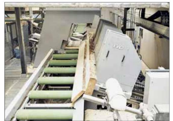
120 m/min möglich, bei Nutzung des Spanners maximal 100 m/min. Eine Besonderheit dieser Blockbandsäge ist die Positionsmessung des Sägeverlaufs in Echtzeit („Live-Position“): Dazu messen je zwei Sensoren den Bandverlauf beim Sägen des Stammes, zwei weitere Sensoren erfassen im Bandrücklauf die Lage der Bandsäge auf der oberen Bandsägerolle. Bei einem „Wandern“ des Bands auf der Rolle wird dies automatisch korrigiert.
