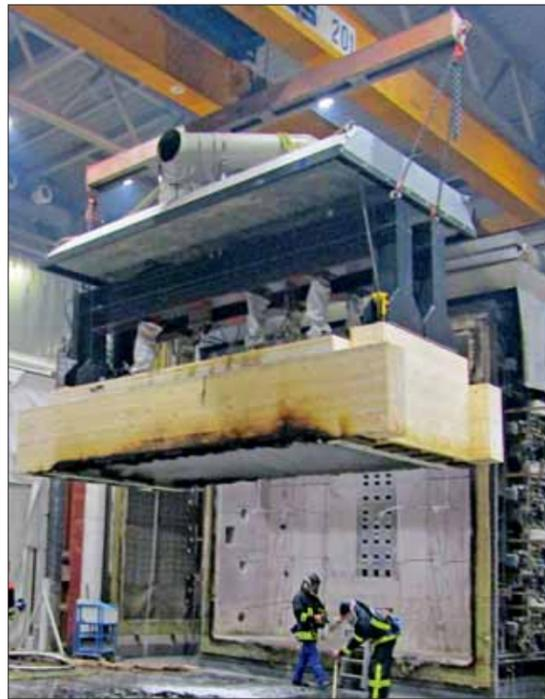
Brandprüfung einer tragenden Holzdecke mit Holzverbindern im Auftrag der Universität Innsbruck
