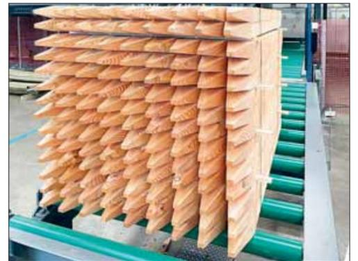
Angespitzte Zaunpfosten oben rund gefräst oder vierseitig abgeflacht in gleichbleibender Qualität produziert Ransford seit März auf einer vollautomatisierten Anlage.
