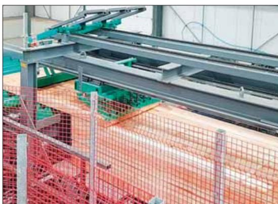
Abschiebeentstapelung mit automatischem Leistenabstreifer
